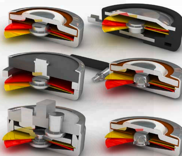
Figura 3: Limitatoare de temperatură cu revenire automată și cu deschiderea în funcție de temperatură, echipate cu arc-disc cu declic suplimentar (curbă neliniară).
