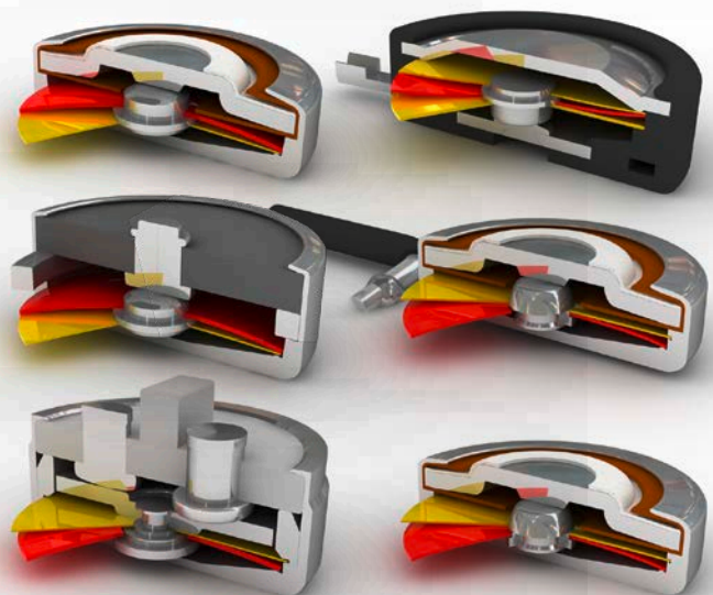
Abb. 6: Automatisch rückstellende und temperatursensitive, öffnende Temperaturbegrenzer mit zusätzlicher Federschnappscheibe (nichtlinearer Verlauf)
