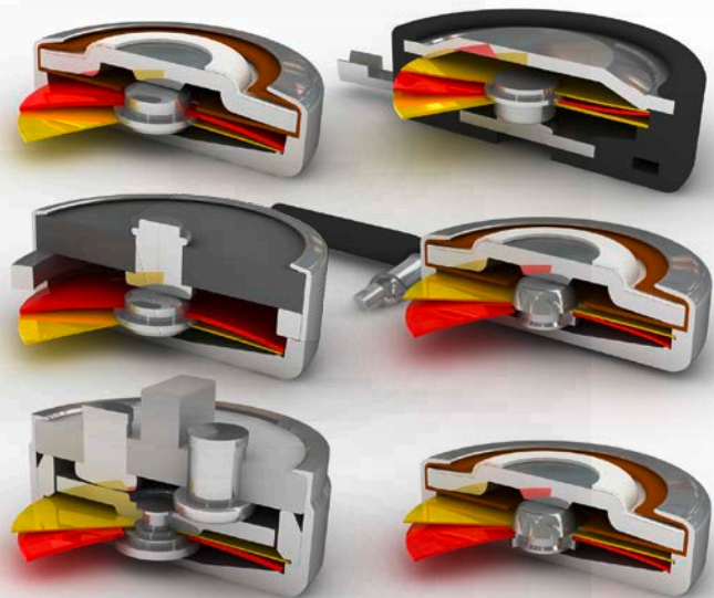
Şek. 3: Otomatik resetlenen ve sıcaklığa duyarlı açıcı tip termik koruyucular, ek esnek snap disk (doğrusal olmayan eğrili) ile
