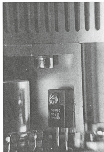
5: Thermik-Anbauschafter mit Befestigungsgehäuse schnappt und den Kontaktstift, der bis dahin durch die Schnappscheibe konstant an den Metalldeckel angeedrückt worden war,
